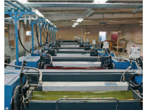
Aus zentralen Tanks erhalten die Farbkästen ständig frische Druckfarbe.
