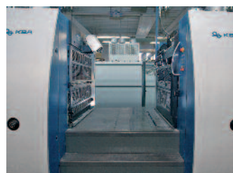
Eine der QualiTronic-Kameras für die Inline-Qualitätskontrolle auf Bogenvorder- (hier im Bild) und -rückseite.
