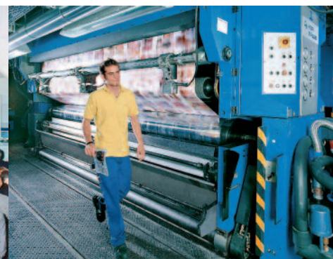
Den ersten Tiefdruck-Jumbo KBA TR 12B mit maximal 4,32 m Papierbahnbreite lieferte »Albert« 2004 an maul-belser in Nürnberg.
