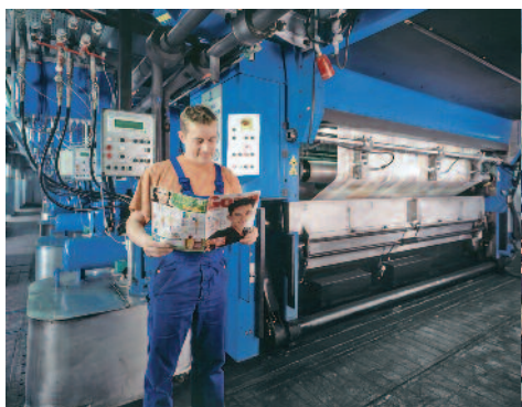
1996: Illustrations-Tiefdruckrolle KBA TR 10B mit 3,60 m max. Bahnbreite für Sebald-Druck (jetzt Burda Druck) in Nürnberg.
