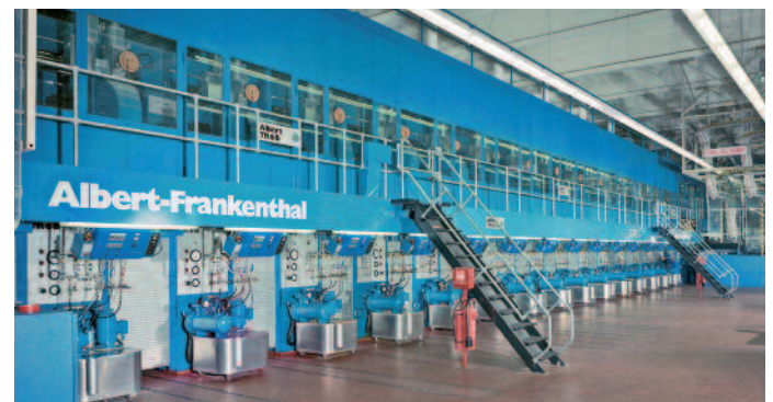
1985: TR 6B-Tiefdruck-Rotationsanlage mit 2,75 m Papierbahnbreite.
