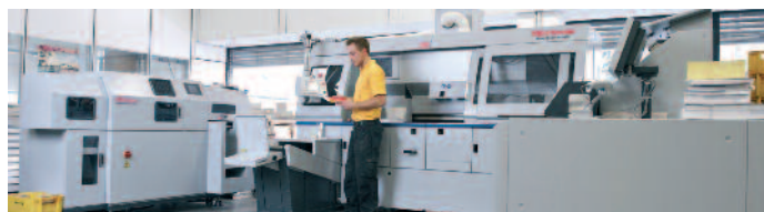
Horizon-Maschinen in platzsparender, arbeitseffizienter Anordnung: (von links) Dreiseitenschneider HT-30, Klebebinder BQ-470 PUR-D und das Hardcover-Bindesystem HCB-2.
