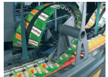
Das RollStream-Vorsammelsystem ist mit insgesamt zehn Anlegern ausgestattet und erfüllt den Trend zum regionalisierten Einstecken.
