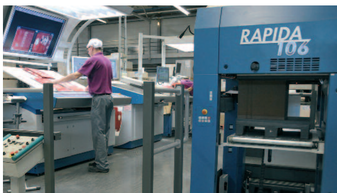
Über die QualiTronic-Kamera für die Inline-Qualitätsregelung erhält der Drucker auch ein Vorschaubild direkt auf den Leitstand.
