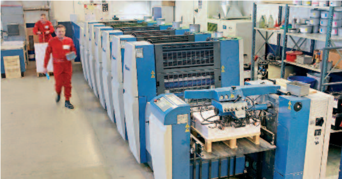
Mit der Rapida 75 hat die Druckerei Klierer eine hochproduktive B2-Maschine im Drucksaal. Aufträge mit Vollflächen und hoher Farbbelegung wandern bei Miroslaw Eichberger automatisch auf die KBA Rapida 75.
