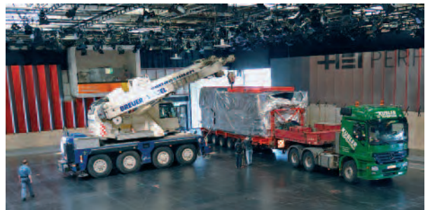
Am 8. Mai wurde die über 200 Tonnen schwere Speedmaster XL 162 in der Heidelberg-Halle angeliefert. Im Zweischicht-Betrieb wurde die Maschine und andere Exponate aufgebaut.
