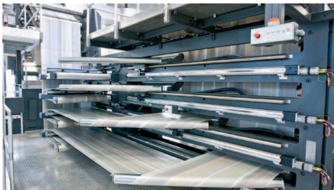
Mit der Falzapparattechnologie und den Wendestangenkonfigurationen wird das Anwendungsspektrum auf unterschiedliche Seitenumfängen erweitert.
