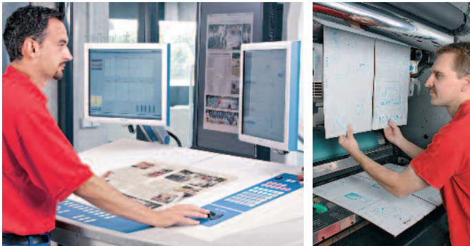
Die Bedienung erfolgt über den KBA ErgoTronic-Leitstand. Zur Rüstzeitverkürzung kann die KBA Commander CL optional mit voll- oder halbautomatischem (im Bild rechts) Plattenwechsel ausgestattet werden.
