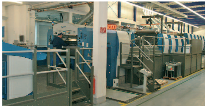
Mit knapp 35 m Länge und umfangreicher Ausstattung für den Kartonagen- und Displaydruck ist die Rapida 162a bei SCA Packaging in Hanau eine der modernsten Bogenoffset-Anlagen für die Verpackungs- und Displayproduktion.
