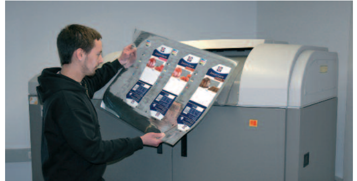
Mit einem Kodak Approval NX Digitalfarbproofsystem werden bei Nägele farbverbindliche, gerasterte Proofs auf Original-Bedruckstoffen ausgegeben.
