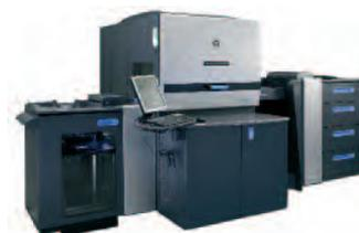
mit bis zu 90 Seiten pro Minute erfolgen kann. Das System bietet einen optionalen »One-shot«-Druckmodus, mit dem sich Plastikkarten, grafische Overlays und andere Anwendungen erschließen lassen, bei denen auf synthetische Materialien gedruckt wird.
