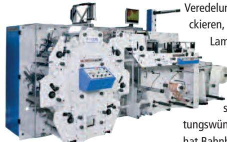
nach jedem Druckwerk. Beeinträchtigungen, die die Wärme der UV-Lampen den Materialien zufügen könnten, werden durch ein Kühlsystem im zentralen Gegendruckzylinder ausgeschlossen.
