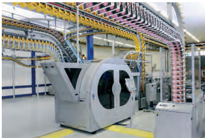
Im Bereich Polybagging verarbeitet der Polypacer Pakete in einer Bandbreite von DIN A4 bis DIN A5. Durch das Versetzen des Inkjet-Kopfes oder das Anbringen eines zweiten Kopfes sind Inline-Beanschriftungen auf das unverpackte und/oder verpackte Produkt möglich.
