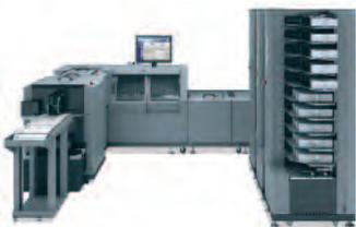
9.000 Broschüren pro Stunde und ist nicht nur für die Verarbeitung von Offset-, sondern besonders von Digitaldrucken geeignet. Laut FKS bietet kein vergleichbares System die Bandbreite vom ›Minibuch‹ bis zum Format DIN A4 quer in Kombination aus klassischer Zusammenstragmaschine und Digitalbogenanleger.
