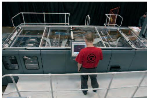
digkeit von 200 m/Min. bei 600 x 900 dpi, verarbeitet Papierbahnen bis zu einer Breite von 135 cm und kann durch die Flexibilität des T-Fold-Falzapparats zahlreiche unterschiedliche Buchformate herstellen.
