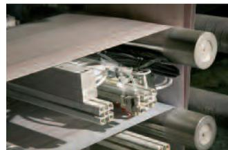
Neu ist Crossjet, die Produktstudie eines auf spezieller Ventiltechnik basierenden Leimsystems, das den kontaktlosen Klebstoffauftrag in der Querleimung ermöglicht. Mit quer zur Papierbahn positionierten Auftragsköpfen werden Klebepunkte
