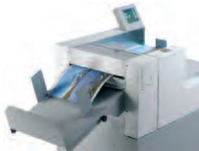
Antwortkarten, Gutscheine, Coupons und vieles mehr in kurzer Zeit herstellen. Die Bedienung erfolgt über Touchscreen, der einfache Werkzeugwechsel über eine vollautomatisierte Wechsellvorrichtung.
