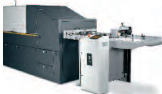
Langformatausleger für bis zu 660 mm lange Bogen. Die bedruckbare Fläche wird mit dieser Option um 27% vergrößert. Zu den Vorteilen des Einsatzes längerer Bogen zählen Anwendungen wie sechsseitige Broschüren, Poster, Schutzumschläge für
