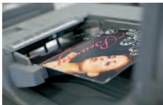
nung und Schrumpfung des Papiers beim Erwärmen und Abkühlen wird intern überwacht, um eine hohe Registerhaltigkeit zu erzielen. Hinzu kommt eine aktive Tonerdichteregelung, die bei größeren Auflagen für eine stabile Farbdichte sorgt.
