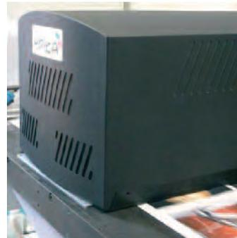
Herstellers eine Geschwindigkeit von bis zu 150 m/Min. im Farbmodus und bis zu 800 m/Min. beim Schwarz-Weiß-Druck. Laut Impika können wasserbasierende, UV- oder MICR-Tinten eingesetzt werden. Als eigenständiges Druckmodul kann die iEngine 1000L auf Offsetdruckmaschinen für den variablen Dateneindruck angebracht werden.
