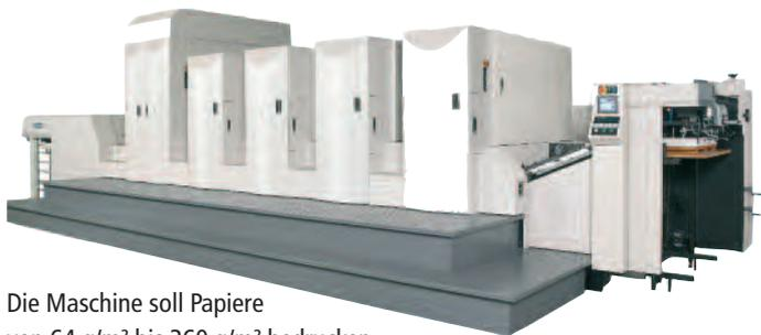
Die Maschine soll Papiere von 64 g/m<sup>2</sup> bis 360 g/m<sup>2</sup> bedrucken, mit einer maximalen Geschwindigkeit von 8.000 Bg/h laufen und liegt mit einem Druckformat von 765 x 580 mm über dem aller Wettbewerber in diesem Formatbereich.
