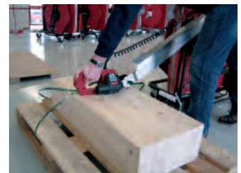
Der Gelenkkopf des neuen Triplex-Tool kann bis zu 90 Grad nach unten gebeugt werden. Damit können auch niedrige Paletten von oben verschweißt werden, ohne dass das Gerät aus der Linearführung ausgehängt werden muss.
