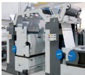
Ausschnitt aus einer Gallus ICS 670-Produktionslinie: links ein Kaltfolienmodul, rechts ein HiDef Flexo-druck-Modul.
