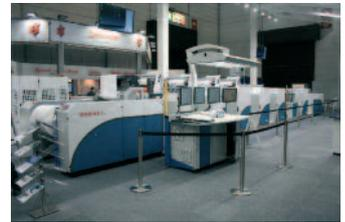
Die formatvariable Verpackungsrolle Varius 80 von KBA-MePrint: Mit einer maximalen Bahnbreite von 800 mm und einer Druckgeschwindigkeit von 400 m/Min., verarbeitet die Varius 80 Bedruckstoffe von 30 bis 800 µm Stärke und ist in der Drucklänge von 21" bis 34" variabel.
