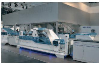
Buchblocks für die Weiterverarbeitung. Jeder Buchblock wird inline auf seine Vollständigkeit überprüft. Durch das Ausschleusen von Einrichtmakulatur während des laufenden Prozesses über eine integrierte Weiche bleibt die hohe Nonstop-Produktivität der Book-on-Demand-Linie sichergestellt.
