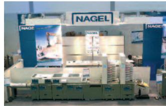
Auf der drupa wurde der 2S Trimmer (2-Seiten-Schneider) für Kopf- und Fußbeschnitt in die Foldnak 100 Linie mit zwei S8 Zusammen-tragtürmen, einem Frontbeschnitt- und Rückenpressmodul integriert, um die geheftete Broschüre an allen drei Seiten beschneiden zu können.
