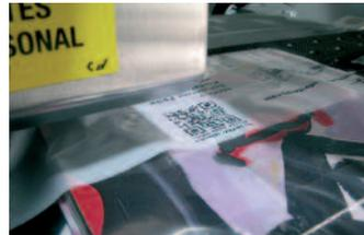
Durch das Versetzen des Inkjet-Kopfes oder das Anbringen eines zweiten Kopfes ist die Inline-Beschriftung auf das unverpackte oder verpackte Produkt möglich.
