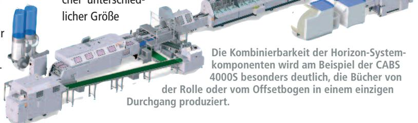
Die Kombinierbarkeit der Horizon-Systemkomponenten wird am Beispiel der CABS 4000S besonders deutlich, die Bücher von der Rolle oder vom Offsetbogen in einem einzigen Durchgang produziert.
