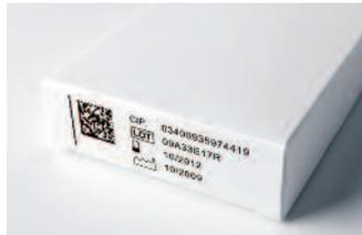
Lösung werden variable Daten in Klarschrift, als 1-D Barcode sowie als 2-D Datamatrixcode aufgebracht. Vericam überprüft die Qualität und steuert, falls notwendig, ein Wastegate an, das unzulängliche Produkte aussortiert.
