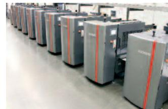
Goss International hat eine Sunday Vpak 500 Rollenoffset-Verpackungsdruckmaschine mit variabler Rapportlänge aufgesetzt und getestet, bevor das System an Precision Press in Minnesota ausgeliefert wurde.
