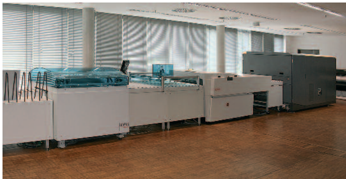
Das Kodak Generation News System mit angegliederter Plattenverarbeitungslinie ist im Pressehaus nur wenige Meter von der Zeitungsdruckmaschine entfernt installiert.
