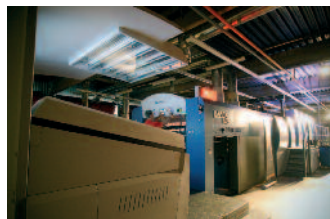
Druckdemo an der KBA Rapida 145, der dank ihrer hohen Automatisierung und bis zu 17.000 Bogen/h Fortdruckleistung produktivsten Großformatmaschine der Welt.
