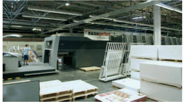
Die Thermo-CtP-Systeme von Kodak versorgen die Großformat-Bogenoffsetdruckmaschinen der Online-Druckerei mit Druckplatten.
