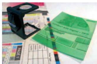
Die Neue nyloflex ACE zeigt einen gleichmäßigen Reliefuntergrund und hohen Farbkontrast.
