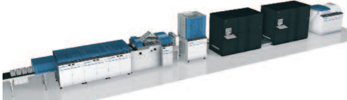
Für die Produktion von Büchern sowie die Direct-Mails kommen neben der Digitaldruckmaschine Abroller von Hunkeler sowie Schneidmodule und Transportsysteme zum Einsatz.
