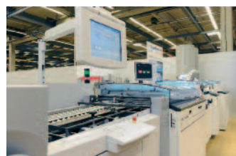
Der Stahlfolder TH 56 von Heidelberg arbeitet als Inlinefolder nahtlos mit den Modulen von Hunkeler zusammen und falzt Bogen, die von einer digital bedruckten Rolle in einem Arbeitsgang abgewickelt und quer geschnitten werden.
