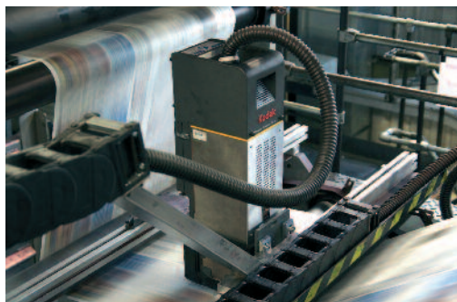
Erhebliche Fortschritte erzielte Kodak bei seinen Eindrückköpfen. Mit dem Prosper-S30-Kopf werden bei Axel Springer in Ahrensburg in einer Rotation Geschwindigkeiten von 13,2 m/Sek. erreicht.
