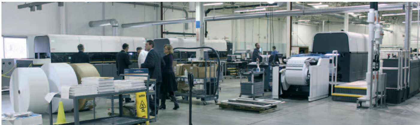
Blick in den Drucksaal bei Mercury Print Productions: Im Hintergrund die zur Prosper 5000XLi aufgerüstete Inkjetmaschine für den 4/4-farbigen Digitaldruck. Rechts die Prosper 1000 für monochrome Anwendungen.
