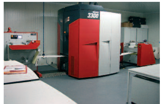
Kein Spiegelbild, sondern die beiden neuen Modelle Xeikon 3030Plus und 3300 beim belgischen Etikettendrucker Femalabel. Damit erhöhte das Unternehmen seine Kapazität um 300%. Die Xeikon 3030Plus ist ein Drucksystem mit 330 mm Rollenbreite und einer Geschwindigkeit von bis zu 15 m/Min.
