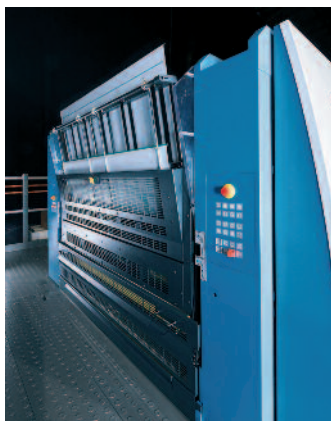
Für den Plattenwechsel gibt es die Automatisierungsvarianten SAPC, FAPC und DriveTronic SPC.
