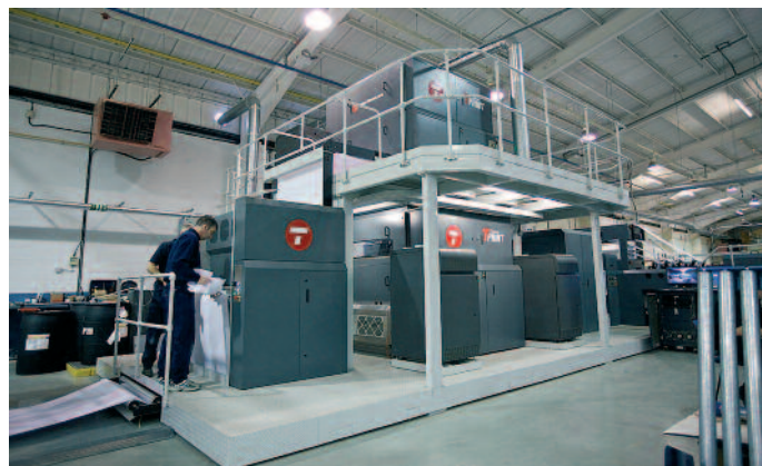
Die Timsons T-Press nutzt wie die Prosper 1000 die Kodak Stream-Technologie, bietet zudem jedoch ein außergewöhnliches Papier-Handling.
