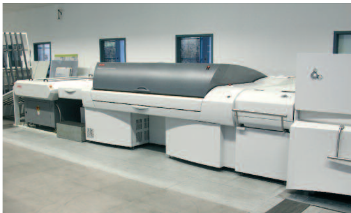
Der vollautomatische Kodak Magnus VLF 5570 Quantum Plattenbelichter mit Mehrkassetteneinheit trägt die Hauptlast der Plattenbebilderung.
