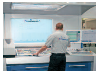
KBA ErgoTronic an der Rapida 106: Optimaler Überblick auch bei 20.000 Bogen/h im Mittelformat
