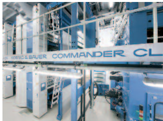
Die flexible Modulbauweise der KBA Commander CL erlaubt eine individuelle Ausstattung und Nachrüstung bei veränderten Produktionsanforderungen
