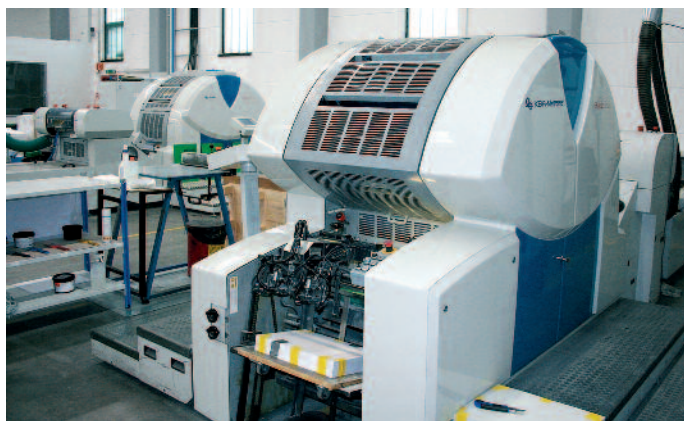
Zwei von fünf Genius-52UV-Maschinen bei flyeralarm. Bei größeren Aufträgen operiert meist nur ein einziger Drucker an zwei Maschinen gleichzeitig. Das ist nur durch die einfache Bedienbarkeit machbar.
