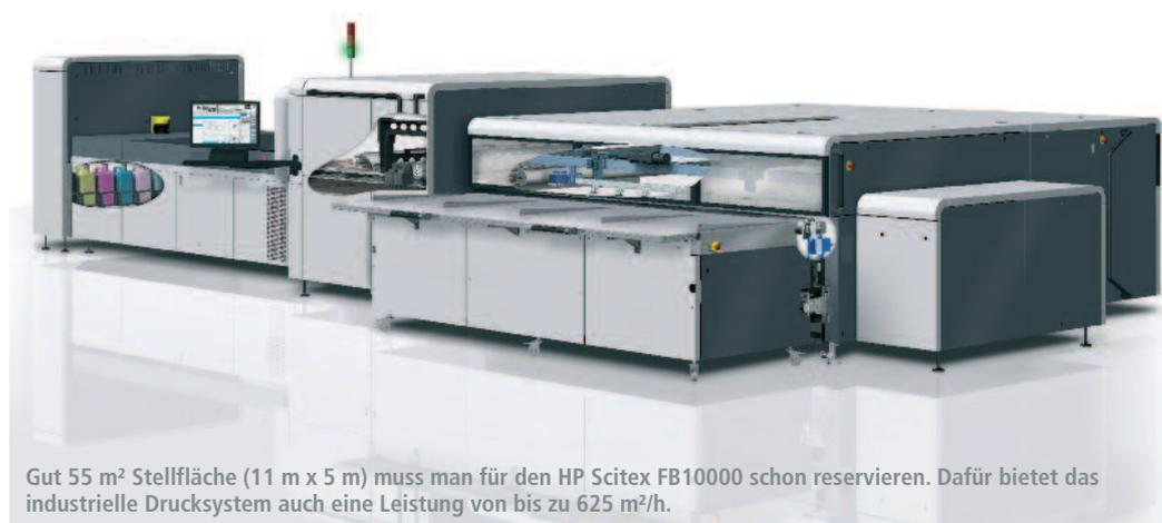
Gut 55 m<sup>2</sup> Stellfläche (11 m x 5 m) muss man für den HP Scitex FB10000 schon reservieren. Dafür bietet das industrielle Drucksystem auch eine Leistung von bis zu 625 m<sup>2</sup>/h.
