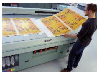
schlaggebend für die Wahl dieser Digitaldruckmaschine war unter anderem die Möglichkeit zur partiellen UV-Lackierung und zum Weißdruck. Dabei werden 4 Tintenkanäle auf die Grundfarben CYMB konfiguriert und die beiden verbleibenden Kanäle auf Lack und/oder weiße Farbe.
