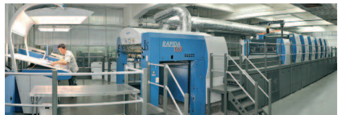
Bei Astros sind Rapida-Maschinen bis zum Format 120 x 162 cm im Einsatz. Hier eine höher gesetzte Rapida 162 mit sechs Farbwerken und Lackwerk.
