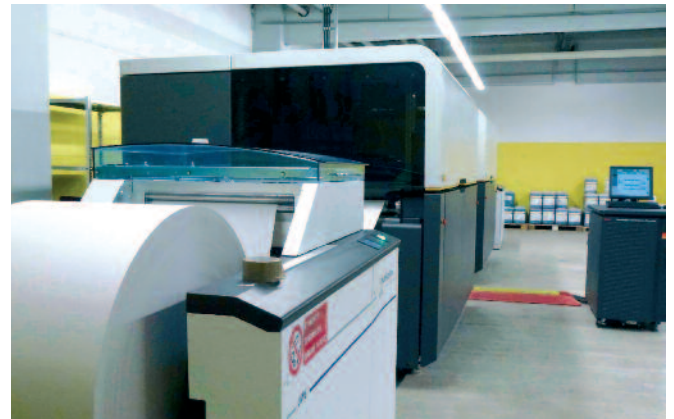
NP Newsprint Berlin druckt mit einer Kodak Versamark VL4200, das Finishing besorgen Maschinen von Hunkeler aus der POPP 6 Baureihe.
