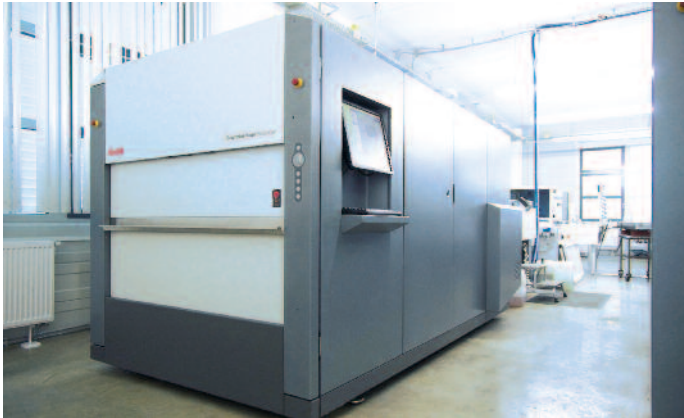
Einer der beiden vollautomatischen Plattenbelichter Kodak Generation News in der Z-Geschwindigkeitsversion in Kempten.
