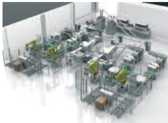
Weiterverarbeitung der zwei 80-Seiten Lithoman mit dem Einzelgreifersystem von Müller Martini und dem kompletten Post Press System von Rima-System.
