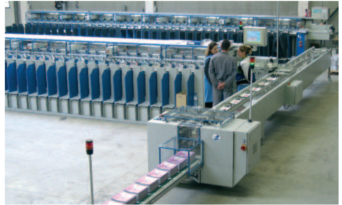
Non-Stop-Auslage an einer Anlage mit zwei koppelbaren Zusammentrag-Automaten mit insgesamt 74 Stationen.
