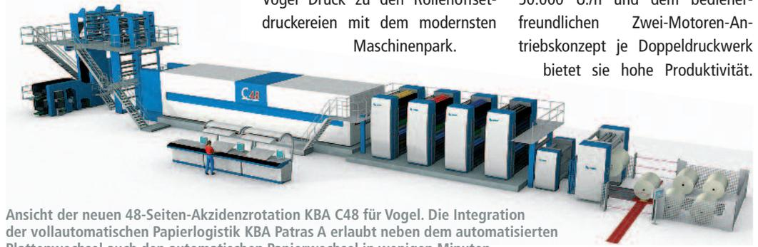
Ansicht der neuen 48-Seiten-Akzidenzrotation KBA C48 für Vogel. Die Integration der vollautomatischen Papierlogistik KBA Patras A erlaubt neben dem automatisierten Plattenwechsel auch den automatischen Papierwechsel in wenigen Minuten.
