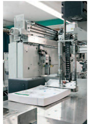
Automatische Beladung des Schnellschneiders über den Hintertisch.
