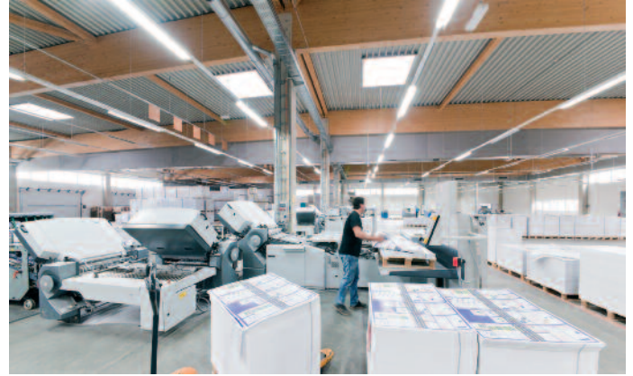
Im Weiterverarbeitungsbereich von Aumüller produzieren bereits zehn Falzmaschinen, die meisten davon Stahlfolder.
