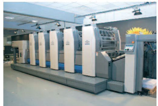
Das CtP-System UVP-46 bebildert UV-Druckplatten bis zum Format 940 x 1.160 mm. Kleinster Rasterpunkt: nur 10 Mikrometer. Die Fünffarben Ryobi 755 G im Technischen Zentrum ist mit einem LED-UV-Trockner von AMS ausgestattet. Auf eine Auslageverlängerung kann verzichtet werden.
