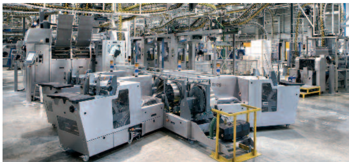
Die hohen Einsteckgeschwindigkeiten mit bis zu 43.000 Ex./h erlauben bei Coldset Printing Partners auf den drei MSD-Linien die Produktion zahlreicher Ausgaben mit hyperlokalen redaktionellen Inhalten.
