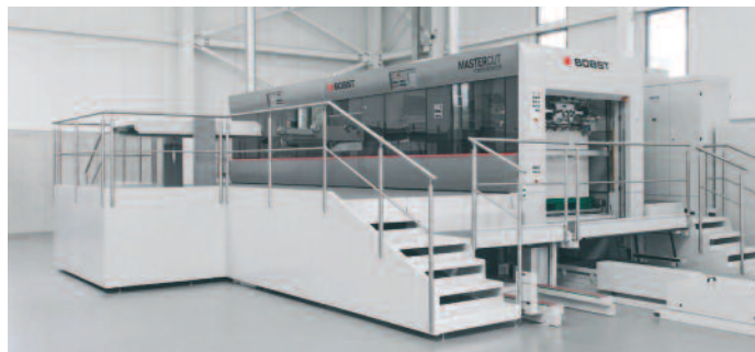
Die Leopold GmbH Verpackungen hat an ihrem Produktionsstandort Marbach eine weitere Hochleistungs-Flachbettstanze Mastercut 145 PER von Bobst installiert.
