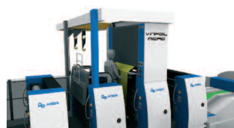
Die gesamte Einrichtung inklusive Kran ist über den Farbwerken der Rapida 106 montiert.
