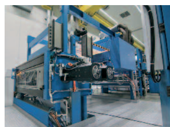
Das von KBA in Kooperation mit der Harris & Bruno Europe GmbH und der Eltosch Torsten Schmidt GmbH entwickelte Lackwerk an der wasserlos druckenden KBA Cortina.
