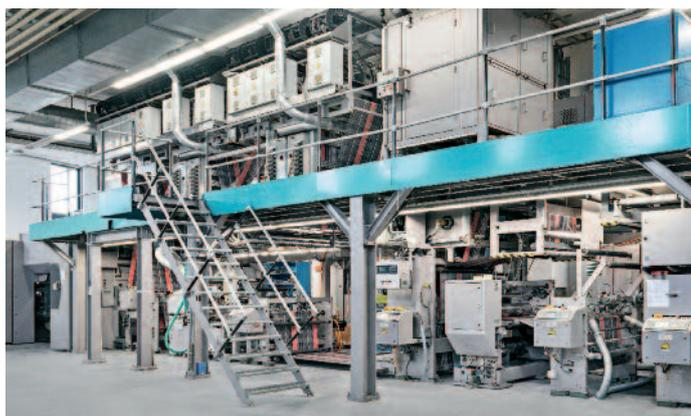
Teilansicht einer Jet Web-Finishing-Linie der Druckerei Kyburz AG mit zwei Inkjet-Towern auf der Galerie der Anlage.
