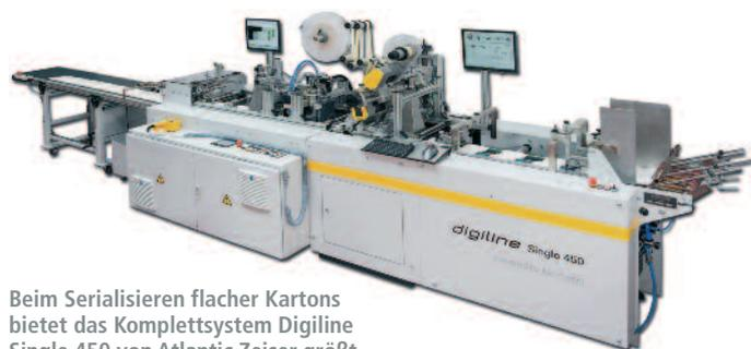
Beim Serialisieren flacher Kartons bietet das Komplettsystem Digiline Single 450 von Atlantic Zeiser größtmögliche Sicherheit. Im Zusammenspiel mit der optionalen Software Medtracker verhindert es versehentliche Fehler der Maschinenbediener.
