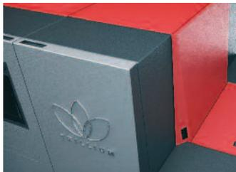
dungsbereiche als Betatester der neuen Druckmaschine gut geeignet. Xeikon Trillium ist eine Flüssigtoner-Technologie, die erstmals auf der drupa 2012 vorgestellt wurde. Die Vierfarben-Druckmaschine erreicht nach Angaben des Herstellers eine Geschwindigkeit von 60 m/Min. bei einer Auflösung von 1.200 dpi und einer Druckbreite von 500 mm. Laborversuche hätten bereits den Nachweis erbracht, dass sich der Durchsatz in Zukunft auf eine Geschwindigkeit von 120 m/Min. erhöhen lasse, heißt es weiter.
