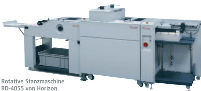
Rotative Stanzmaschine RD-4055 von Horizon.
