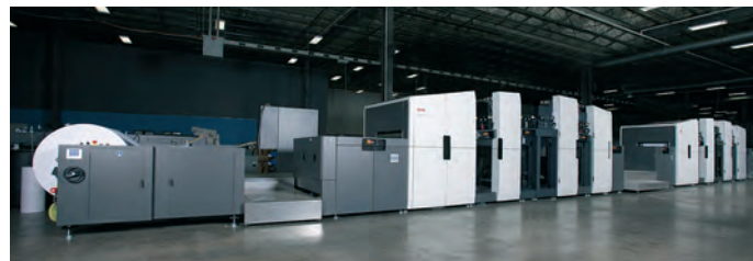
Die Prosper 6000C Druckmaschine bedruckt matt gestrichene und ungestrichene Papiere bei Bahngeschwindigkeiten bis zu 300 m/Min.
