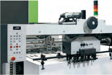
Das gesamte Maschinenkonzept der dmax von Steinemann Technology ist auf hohe Leistungen ausgelegt. Der Einzelbogenanleger von KBA, der Bogenreinigungskalander, der extrem präzise
