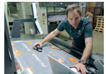
Neutrale Messung des Umgebungslichtes und Ist-Analyse der Abmusterungsbedingungen.
