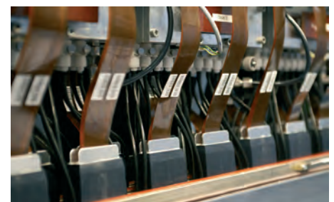
duktivität durch die überlappend angeordneten 20 Ricoh-Inkjet-Druckköpfe.
