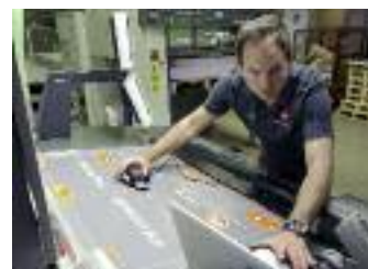
Neutrale Messung des Umgebungslichtes und Ist-Analyse der Abmusterungsbedingungen.
