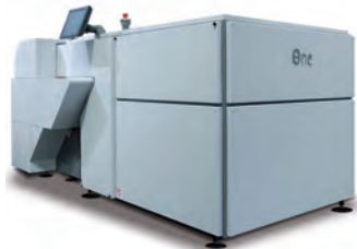
Der neue OneAutoloader von marks-3zet, hier in Kombination mit dem 8-Seiten CtP-Belichter One CtP 1100.
