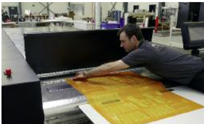
Nach UV-Belichtung und Entfernen des TIL werden die Kodak Flexcel NX Platten in einer automatischen Verarbeitungslinie ausgewaschen und getrocknet.
