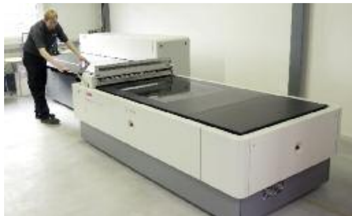
Der Kodak Flexcel NX Wide Belichter (im Hintergrund) mit dem unmittelbar daneben aufgestellten Flexcel NX Wide Laminator in der Produktionshalle.
