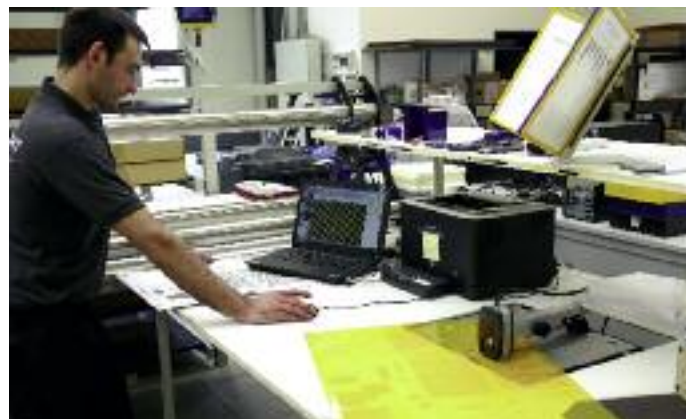
Eine fertig verarbeitete Kodak Flexcel NX Platte in der messtechnischen Qualitätskontrolle.
