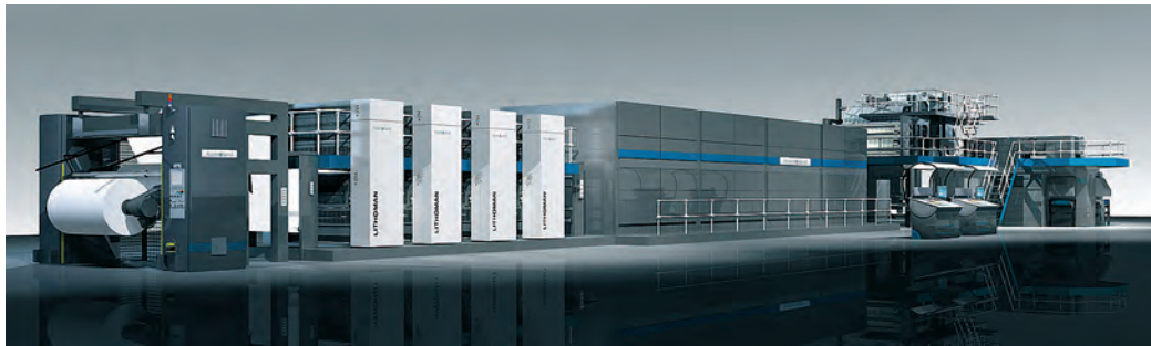
Die 80-Seiten-Lithoman mit autoprnt-Ausstattung für Stark Druck bietet hohe Produktivität und Wirtschaftlichkeit. Die Weiterverarbeitung hinter der Maschine kommt von Gämmerler.
