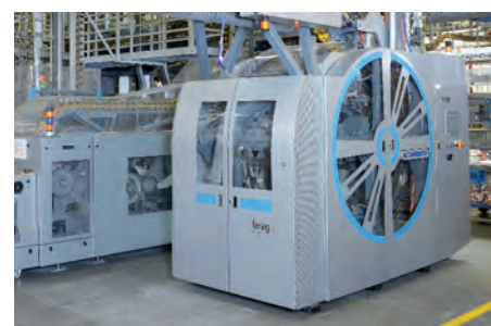
Die Integration des Dreiseitenbeschnitts in ein Weiterverarbeitungssystem bringt Vorteile.
