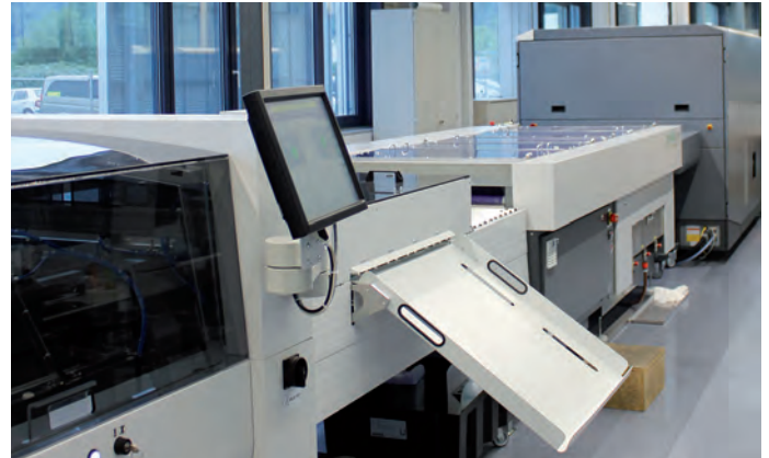
die Plattenlinie, die aus Kodak-CtP-System, Entwicklungseinheit von marks-3zet und Platten-Finishing von NELA besteht.
