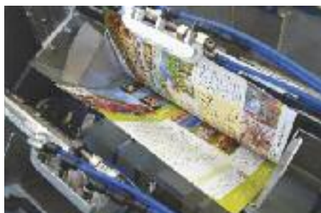
Auf der Einstecklinie MiniSert können jetzt auch Produkte ohne Vorfalz verarbeitet werden.
