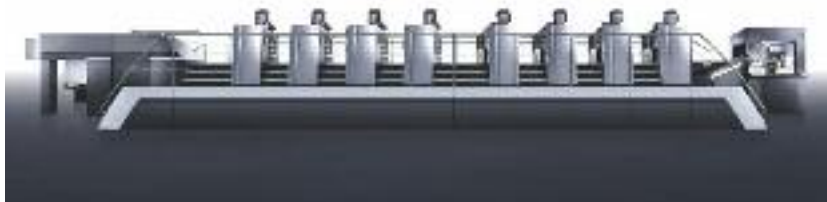
Bis zu 18.000 Bogen pro Stunde auch im Wendebetrieb kann die neue 8-Farben-Maschine im Druckhaus Weppert verarbeiten.
