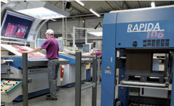
Automatisierte Paletten- und Stapellogistik an der Auslage einer KBA Rapida 106: Unter dem Maschinenpodest hindurch werden die Paletten für den nachfolgenden Stapel vom Anleger zur Auslage befördert.
