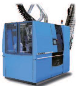
Das in das Einstecksystem ProLiner integrierte Hefttaggregat ProStitch erlaubt zusammen mit dem Fächerschneider NewsTrim (Bild) eine Inline-Produktion mit Einstecken, Heften und Schneiden.
