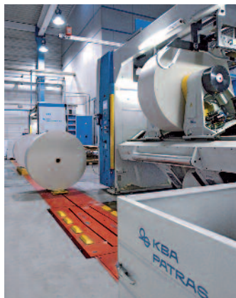
Automatische Rollenbeschickung und Restrollen-Entsorgung mit KBA Patras.
