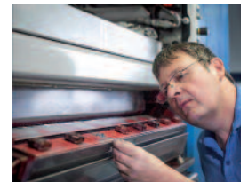
Prüfung der Düsen der deltaspray-Sprühfeuchtwerke.
