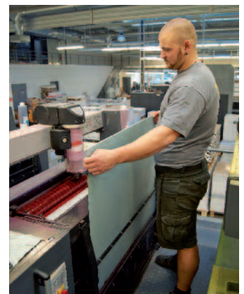
Druckteam-Mitarbeiter Dustin Richter beim Plattenladen an einer der Bogenoffsetdruckmaschinen.
