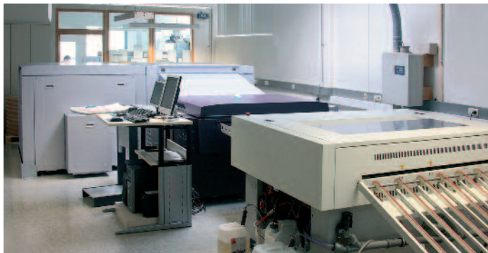
Die wichtigsten Komponenten des vollautomatischen CTP-Ensembles im Überblick: links hinten die Mehrkassetteneinheit, rechts daneben der Autoloader und davor der Kodak Magnus 800 Quantum Plattenbelichter mit
