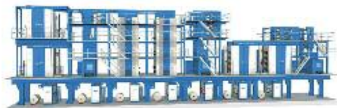
Die KBA-Zeitungsdruckanlage bei der »Main-Post« nach der Erweiterung: links die beiden zu einem 16er-Turm aufeinander gesetzten Commander CT-Achtertürme, rechts daneben die herkömmliche Commander-Rotation, die mit nur acht Druckstellen in einem Turm etwa genauso hoch ist. Ganz rechts die neue Maschinensektion der Commander CT.
