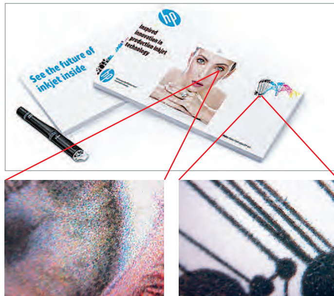
Das Druckmuster, das uns HP zur Verfügung stellte, unter dem Mikroskop: Selbst bei 64-facher Vergrößerung lassen sich keine Raster- oder Sägezahn-Effekte entdecken.
