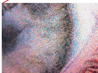
Das Druckmuster, das uns HP zur Verfügung stellte, unter dem Mikroskop: Selbst bei 64-facher Vergrößerung lassen sich keine Raster- oder Sägezahn-Effekte entdecken.
