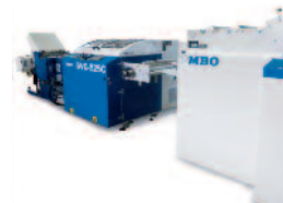
Digitale Weiterverarbeitungslinie von MBO und Herzog+Heymann zur Insert-Produktion.
