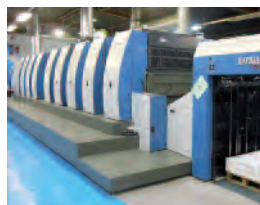
Die neue Achtefarben-Rapida 106 mit HR-UV produziert hochwertige Bildbände und Akzidenzprodukte zu wettbewerbsfähigen Preisen in exzellenter Qualität.
