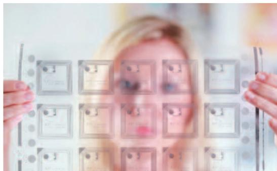
Der Begriff Printed Electronics steht unter anderem für elektronische Anwendungen, die per Druckverfahren hergestellt werden. So werden heute beispielsweise bereits RFID-Lösungen, Sensoren oder Solarzellen mit dieser Methode hergestellt.
