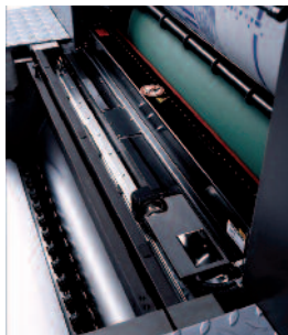
Das neue Inline-Farbmesssystem Prinect Inpress Control 2 von Heidelberg reduziert durch schnelleres Einrichten die Rüstzeit und die Makulatur. Das System misst und regelt Farbe und Passer auch bei laufender Produktion.
